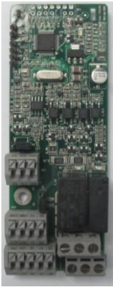
IO expansion card EC-IO501-00
