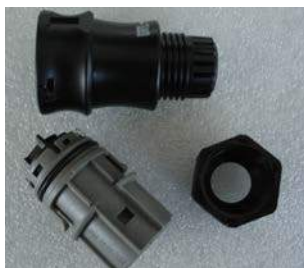
▲ Hình 4.14 Cực nối lưới điện xoay chiều
