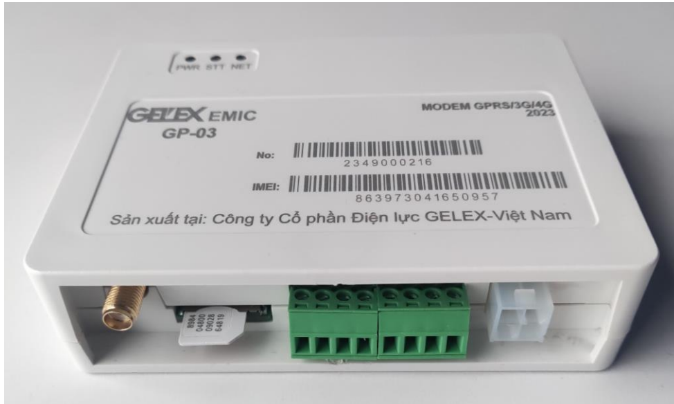
Hình 3: Vị trí lắp SIM
