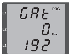
Fig. Gateway (GAt), byte 0, value 192
