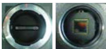
Một dây gồm 64 điểm cảm ứng ở vòi LINE SENSOR Một điểm cảm ứng duy nhất ở vòi thông thường
