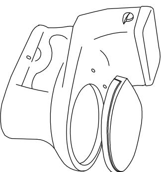
6. Lắp dây cấp với van dừng, cố định bàn cầu và làm kín chân bàn cầu bằng silicone./ *Connect the flexible hose with the stop valve fixed the toilet then the close leg by silicone.*
