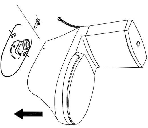
10. Lắp dây cáp với van dừng.
