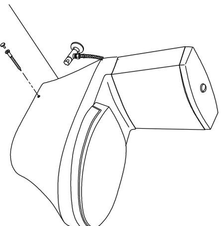
12. Làm kín chân bằng silicone. / Close leg by silicone.
