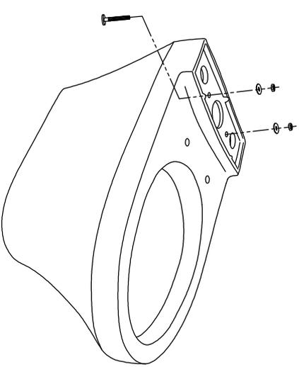
7. Lắp kết nước vào thân cầu. / Install the tank with the toilet body.
